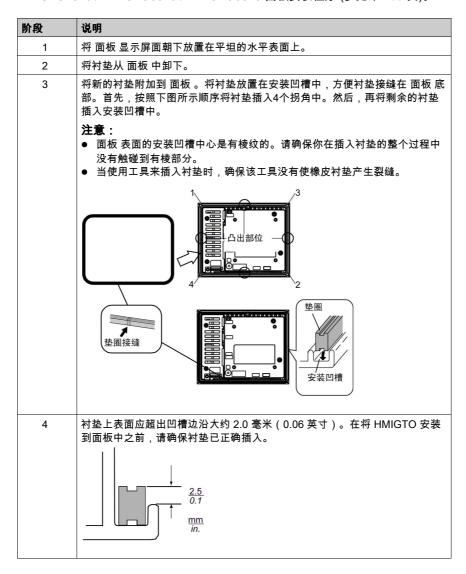
衬垫必须正确插入凹槽中,从而为 面板 做到 IP65f 级别的防潮(对于HMIGTO2315/HMIGTO5315/HMIGTO6315,防潮级别为 IP66k)。
