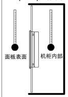
请确保周围设备的散热不会导致 面板 超出其标准工作温度。
